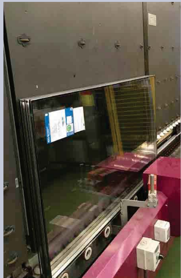
Instalaciones TERMIGLASS. Llenado automatizado de gas argón. Empresa certificada en el mercado CE argón por laboratorio externo. Foto Guardian Select™. Todos los derechos reservados.
